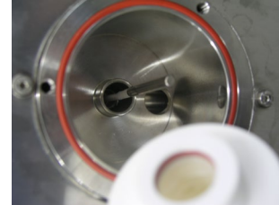
Fig. 7: Neue Abluftfilterkerze einsetzen
