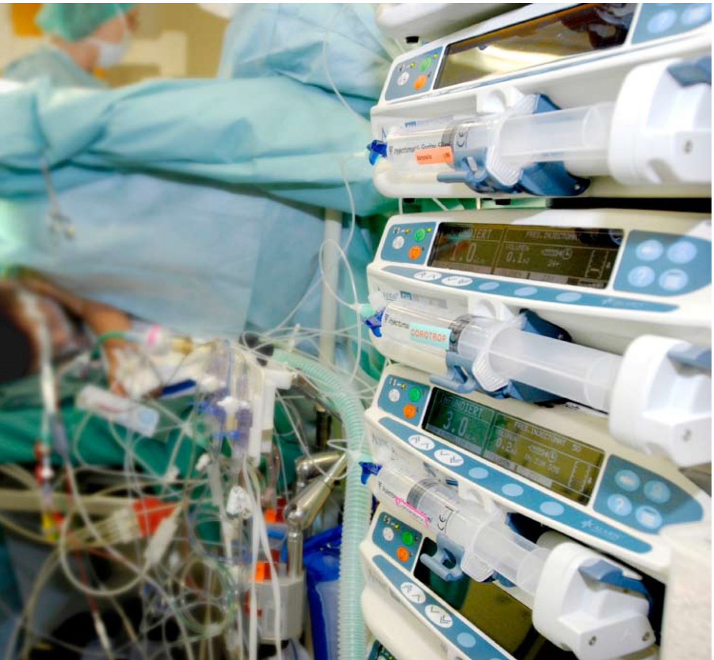
Spritzenpumpen für Kinder müssen kleinste Mengen an Medikamenten mit höchster Präzision ausstossen können.
